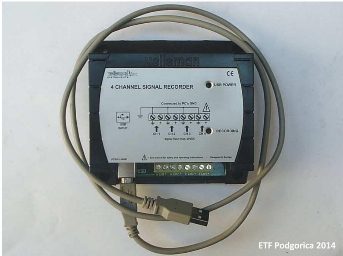
*Slika 3.2 Velleman PCS10 četvorokanalni snimač (akvizicioni modul)*
